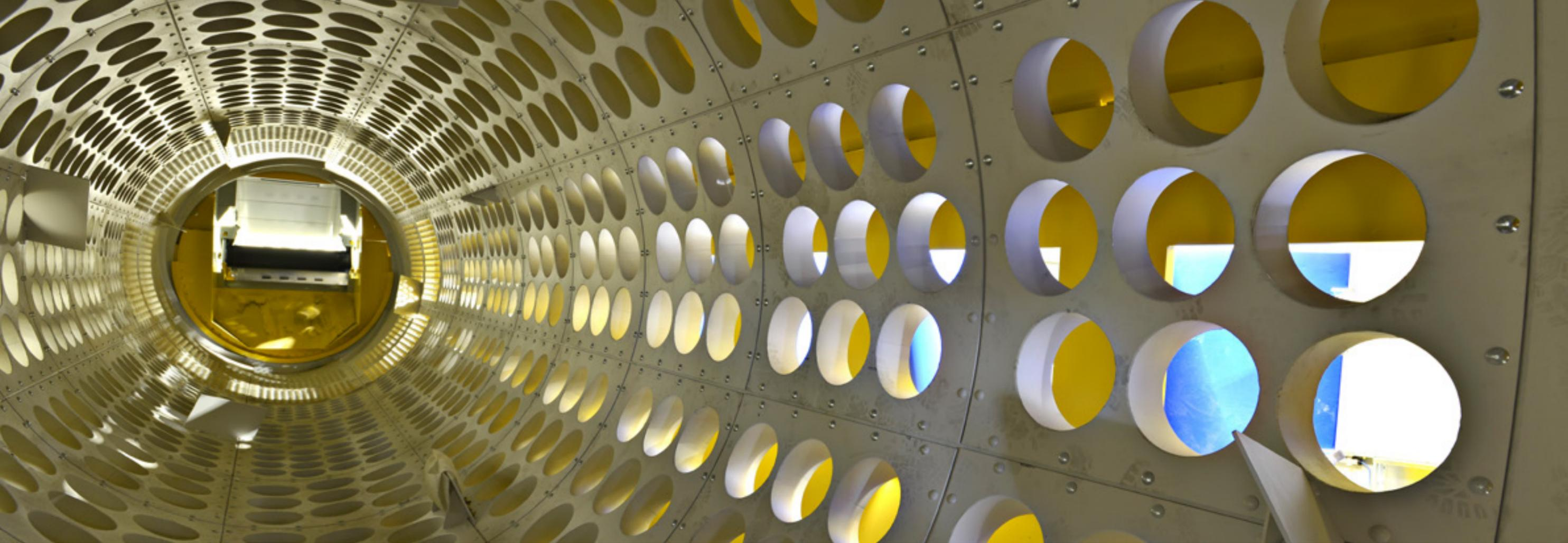
STADLER Siebtrommeln zeichnen sich durch eine besondere Robustheit aus. Gefertigt aus 10 Millimeter starkem Stahl (z. B. Hardox) sind sie in hohem Maße verwindungssteif. Ausgestattet mit großzügig dimensionierten Laufstegen, Brücken und Türen sowie Innenbeleuchtung, zeichnen sie sich als betont wartungsfreundlich aus.
