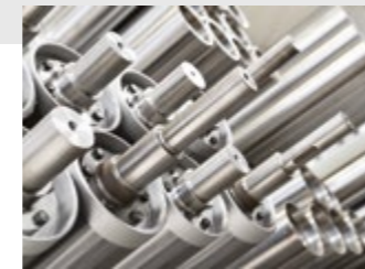
Antriebs- und Umlenktrommel dynamisch gewuchtet
