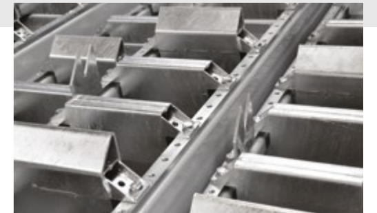
Besonderheiten Spezielle Paddelanpassung zur Optimierung der Kartonagentrennung
