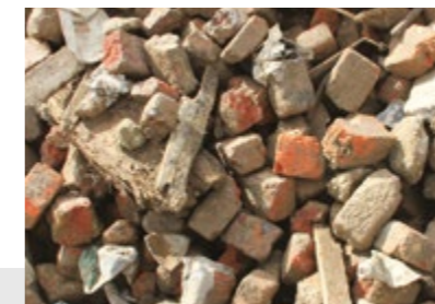
Deponieaushub 2-stufige Trennung: Absieb 90 - 200 mm
