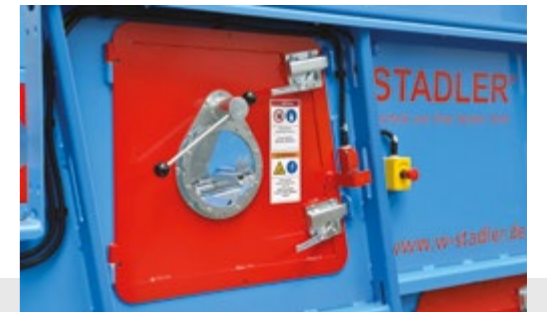
Wartungstüre Einfacher Zugang zum Inneren des Separators für Wartungs- und Reinigungszwecke
