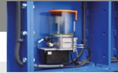
Schmierung Zentralschmierung während des Betriebs
