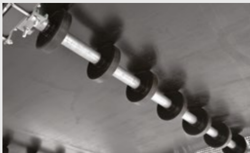
Untertrum – getragen von Untergurtrollen (im Bild: verwicklungsarme Ausführung)
