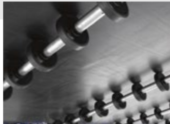
Partie inférieure - portée par des rouleaux de renvoi
