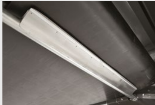
Les racleurs gardent la surface de la bande propre
