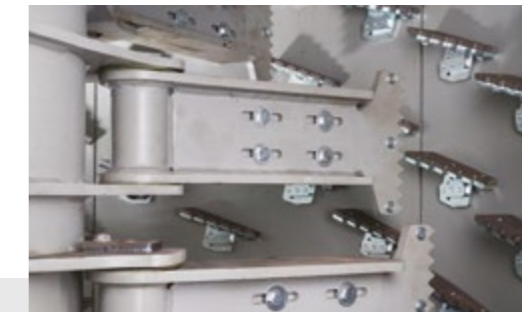
Rotor avec bras rotatifs
