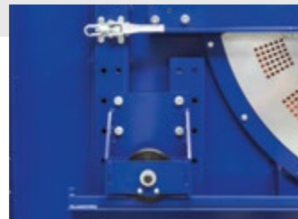
Réglage en hauteur du tambour
