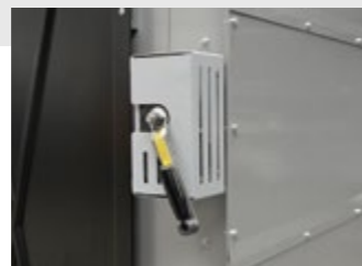
Treuil permettant de régler la plaque de guidage
