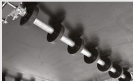
Partie inférieure – portée par des rouleaux de renvoi (sur l'image: rouleau à faible enchevêtrement)
