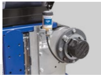
Cartouche de graissage assurant une lubrification permanente
