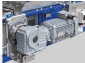
Entraînement poussant avec interrupteur de maintenance
