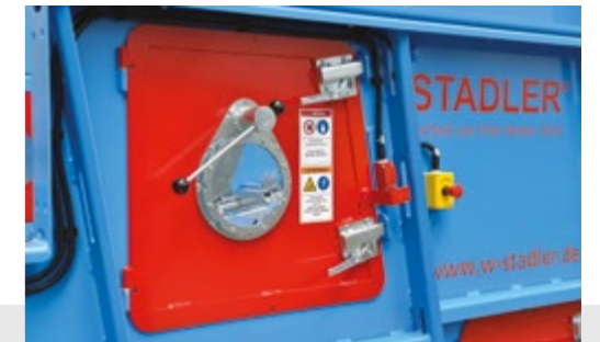
Porte di manutenzione Accesso più agevole alle parti interne del separatore per operazioni di manutenzione e pulizia
