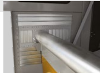
Vista interna del sistema di regolazione del deflettore mobile
