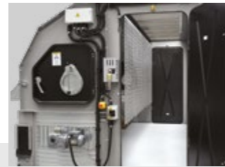
Piattaforma di manutenzione estraibile
