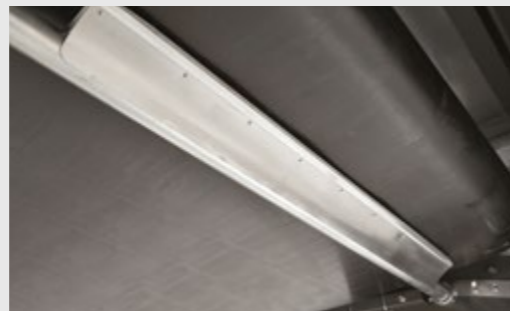
I raschiatori mantengono pulita la superficie del tappeto
