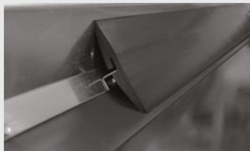
Guarnizione liscia tra la parete laterale e il tappeto
