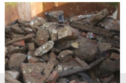
Frazione rotolante Frazione 3D con pezzatura maggiore di 200 mm
