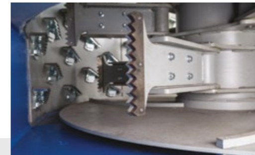
Le lame sono realizzate in acciaio ad alta resistenza
