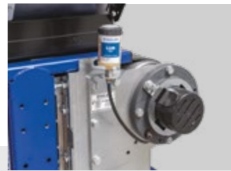
Cartuccia di lubrificazione per una lubrificazione continua
