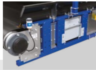
Scomparto per posizionamento dei sensori
