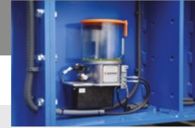
Lubrificazione Lubrificazione automatica durante il funzionamento
