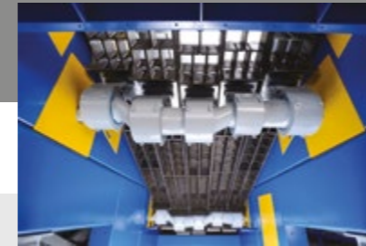
Alberi Diametro di 280 mm per la massima stabilità
