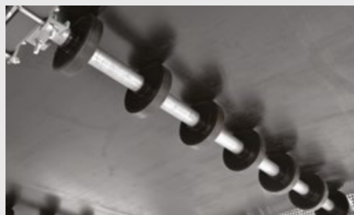
Superficie inferiore del tappeto trasportata da rulli di ritorno
