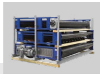
Costruzione modulare, per costi di trasporto ridotti da larghezza 2100 in poi
