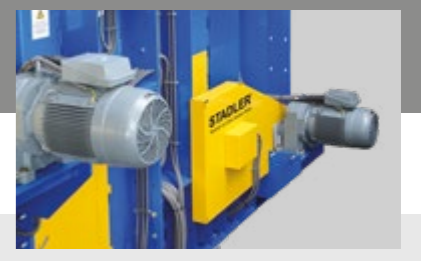
Due motori Soluzione di trasmissione esclusiva per una maggiore durata degli alberi
