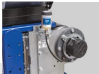
Cartuchos de lubrificação para lubrificação contínua
