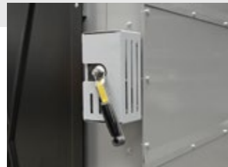
Manivela com cabo para ajuste do defletor interno
