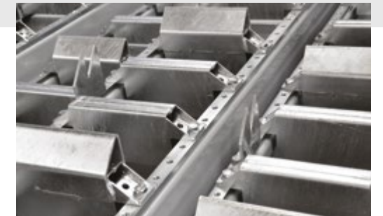
Particularidades Ajuste especial das pás para otimização da separação de papelão
