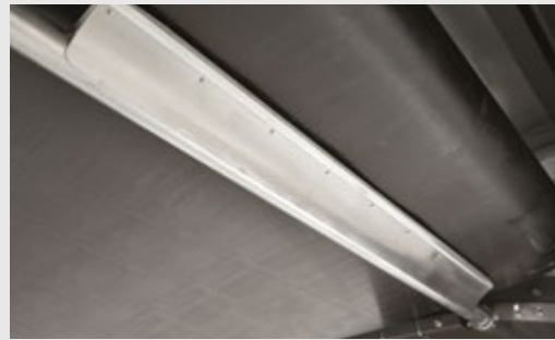
Raspadores mantêm a superfície da esteira limpa
