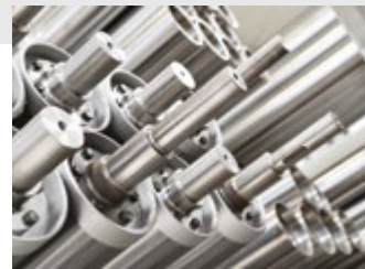
Tambores de acionamento e retorno balanceados dinamicamente
