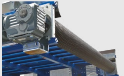
Motores de acionamento com redutores de engrenagens cônicas
