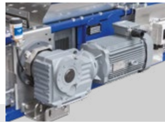
Acionamento na parte traseira com interruptor de manutenção
