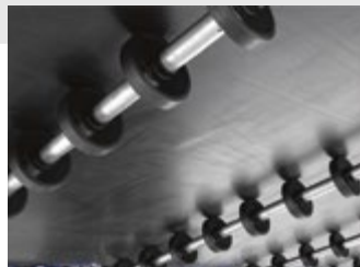
Trecho inferior com roletes fixos e roldanas individuais
